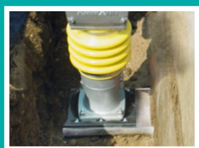
asymetrická patka 340 mm: hutnění v příkopech chráněných bedněním:
