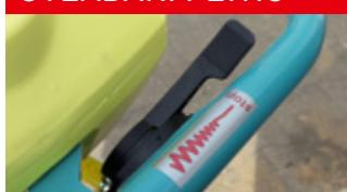
Optimalizovaná multifunkční páka plynu usnadňuje ovládání a zajišťuje šetrnou manipulaci s motorem, díky čemuž je maximálně prodloužena jeho životnost.
