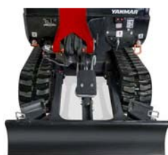
Zúžený podvozek: 980 mm
