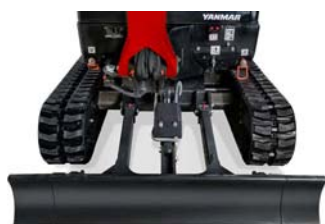
Rozšířený podvozek: 1170 mm
