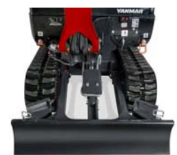
Zúžený podvozek : 980 mm
