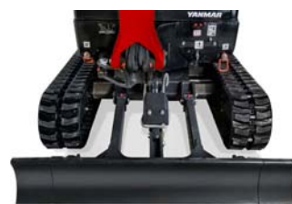
Rozšířený podvozek : 1 380 mm
