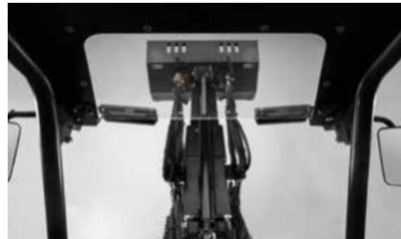
Střešní okno Střešní okno z 10mm polykarbonátu - certifikováno FOPS. 115980302
