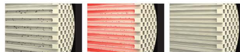
1. Zachycení pevných částic 2. Zahájení regenerace 3. Dokončení regenerace*
